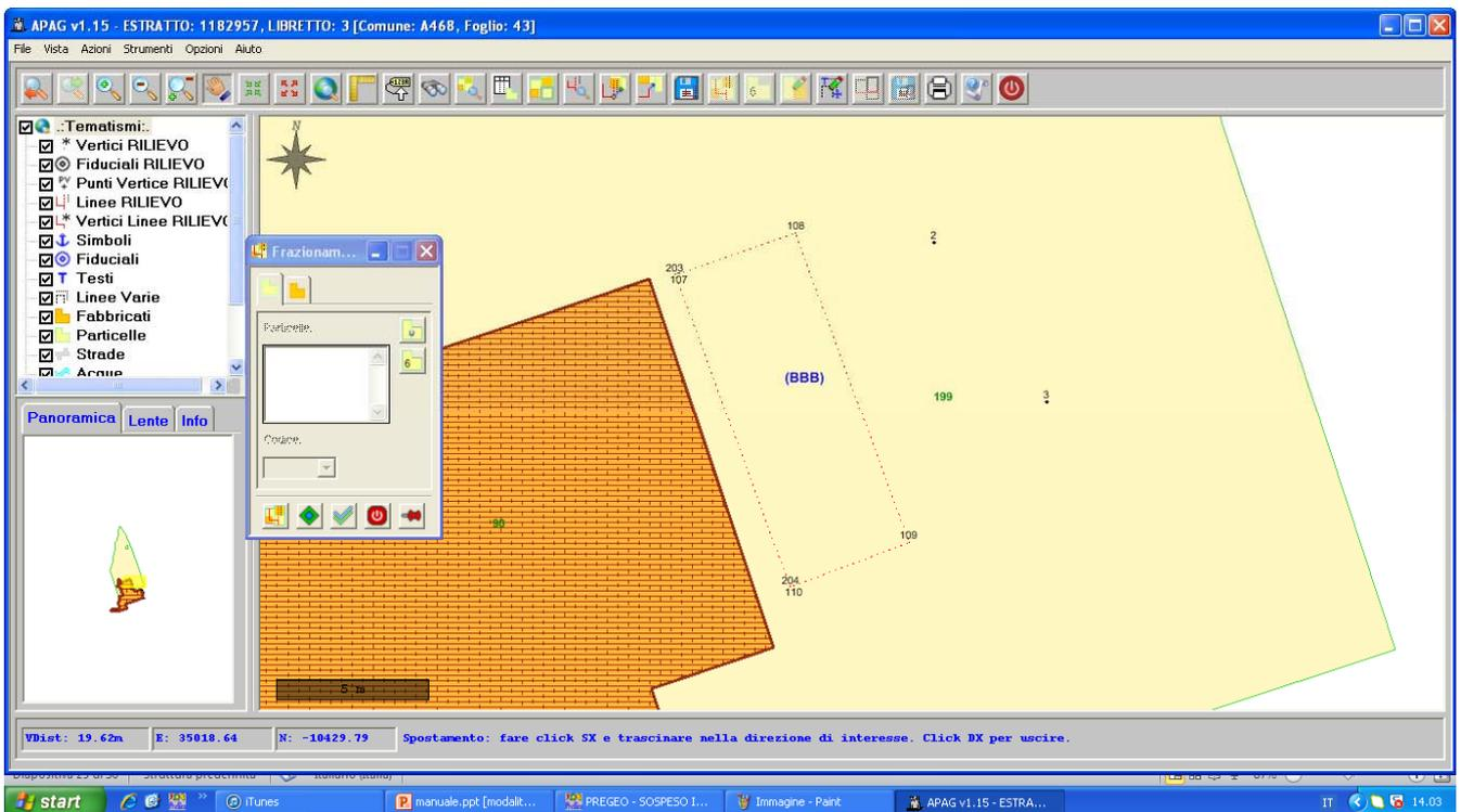
Fig. 15 – Creazione di una particella interrata; frazionamento
